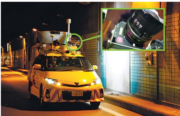
8K動画カメラを搭載した点検車両。光を照射してひび割れを検出する。
